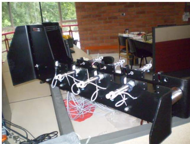
Figura 56. Cilindros neumáticos, sensores ópticos, tambor, lamina de soporte cámara CCD y placas estructurales
