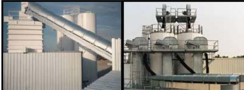
Figura 18. Bandas transportadoras de alimentación. Tomado de [www.sweetmfg.com/bandatransportadora.pdf](http://www.sweetmfg.com/bandatransportadora.pdf)
