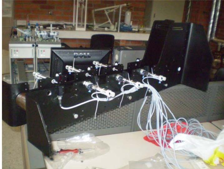
Figura 57. Cilindros neumáticos, sensores ópticos, tambor, cableado y placas estructurales.
