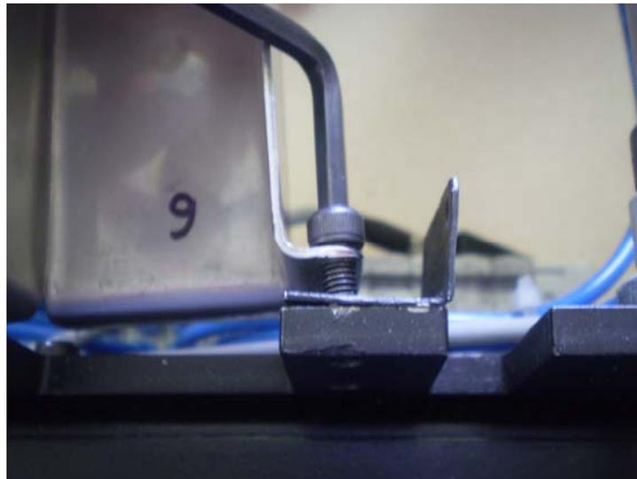
Figura 60. Caja de almacenamiento, placa estructural, placa de soporte de sensores ópticos en L y tornillos de sujeción.
