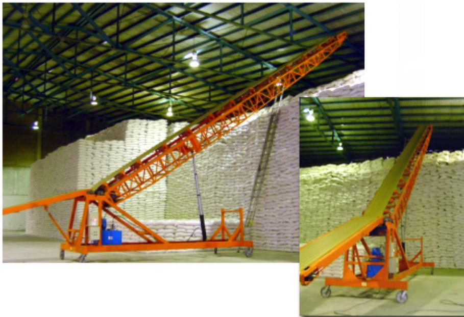
Figura 19. Banda transportadora a granel. Tomado de <http://www.bandas.com.mx/transportadores.htm>
