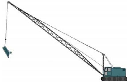
Figura 17. Sistema de poleas para el transporte de productos de un sitio a otro. Tomado de Elementos de Máquinas, Hamrock, Jacobson, Schmid. Ed. Mc Graw Hill, México, 1999.
