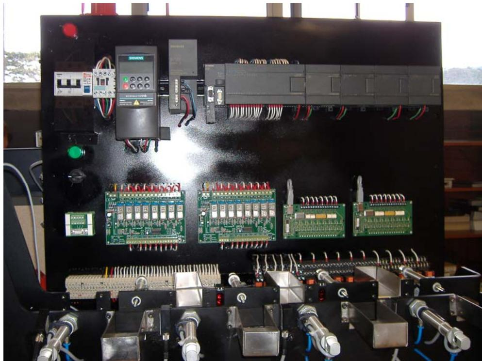
Figura 64. Tablero de control y modulo seleccionador de objetos
