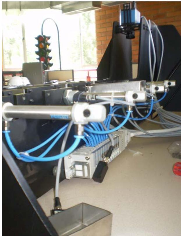
Figura 58. Cilindros neumáticos, sensores ópticos, isla de válvulas, lamina de soporte cámara CCD, cámara CCD, cajas de almacenamiento, cableado eléctrico, cableado neumático y placas estructurales
