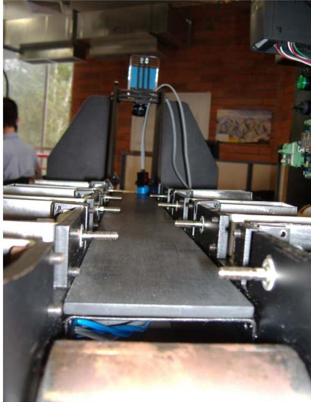
Figura 59. Cilindros neumáticos, sensores ópticos, sensor óptico análogo, sensor inductivo, lamina de soporte cámara CCD, cámara CCD, cajas de almacenamiento, cableado eléctrico, tambor y placas estructurales.
