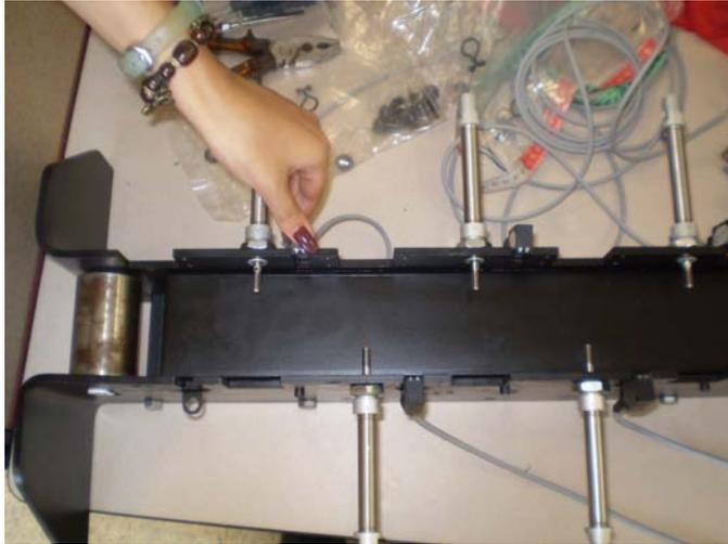
Figura 52. Cilindros neumáticos, sensores ópticos, tambor, placa en u y placas estructurales
