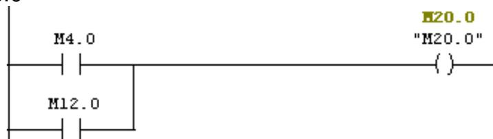
**Figura 235. Bobina auxiliar de los motores**
