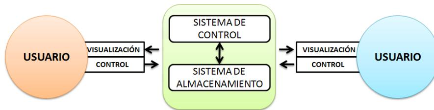
**Figura 6.** Estructura básica de un sistema de supervisión y mando [7][8]
