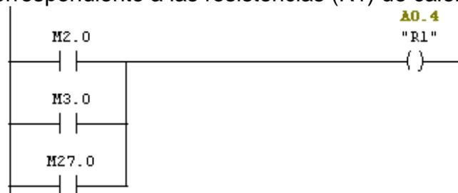
**Figura 226. Resistencia de calentamiento R1**
