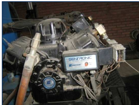
Figura 2. Compresor Semi-hermético Copeland
