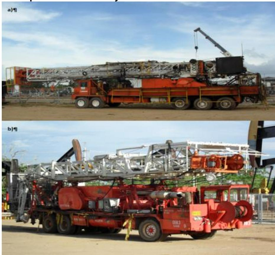
**a)** Equipo de Workover y **b)** Equipo de Varilleo.
