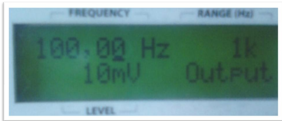
Figura 61. Generador de señales ajustado a 100Hz, amplitud de 10mV y señal sinusoidal. Fuente: Autor del texto.
