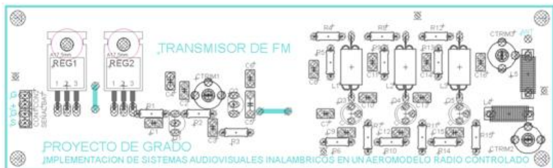
Figura 44. Cara superior del circuito impreso del transmisor de FM. Fuente: Autor del texto.
