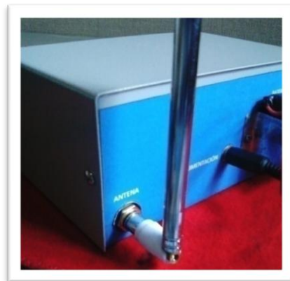
Figura 99. Correcta instalación de la antena en el transmisor de FM. Fuente: Autor del texto.
