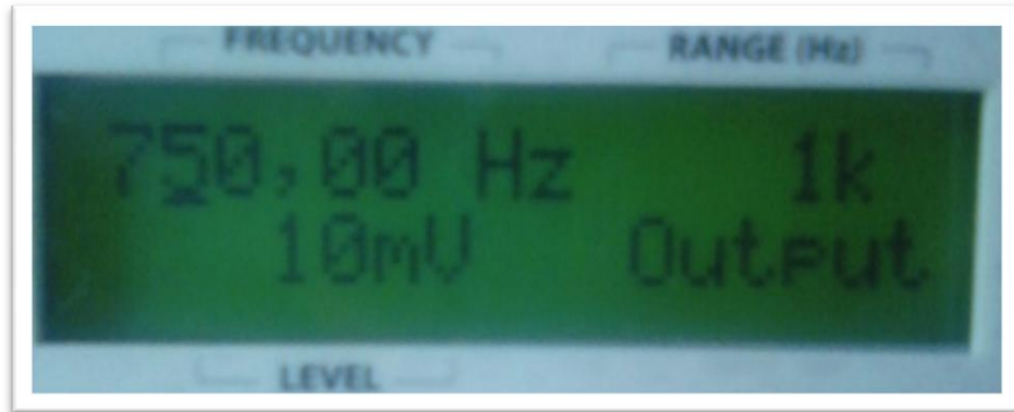
Figura 63. Generador de señales ajustado a 750Hz, amplitud de 10mV y señal sinusoidal. Fuente: Autor del texto.
