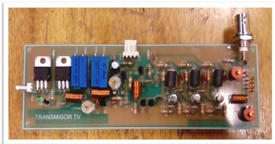
Figura 52. Circuito impreso del transmisor de AM elaborado en fibra de vidrio. Fuente: Autor del texto.
