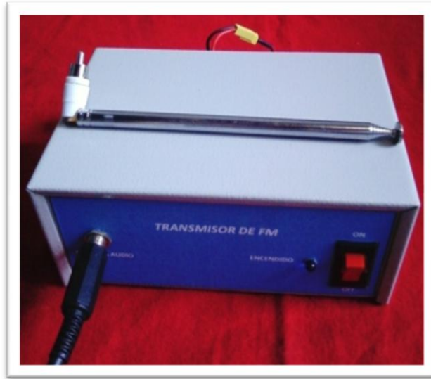
Figura 98. Terminal de conexión para antena del transmisor de FM. Fuente: Autor del texto.
