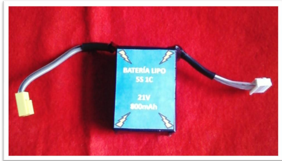
Figura 103. Batería Lipo 5S 1C para alimentar al receptor de FM y al transmisor de AM. Fuente: Autor del texto.
