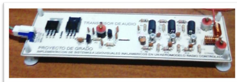
Figura 50. Circuito impreso del transmisor de FM elaborado en fibra de vidrio. Fuente: Autor del texto.
