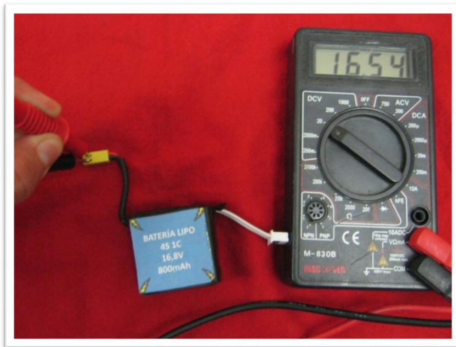
Figura 88. Medición de tensión en batería Lipo 4S 1C. Fuente: Autor del texto.
