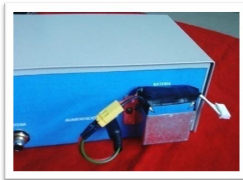
Figura 90. Batería correctamente instalada en el transmisor de FM. Fuente: Autor del texto.
