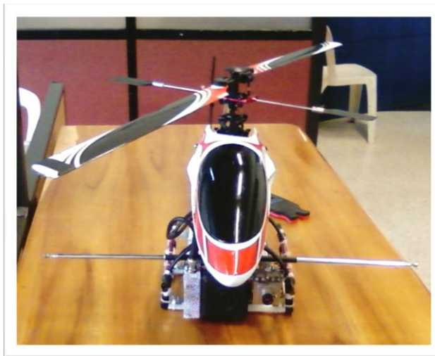
Figura 27. Antena dipolo instalada en el helicóptero. Fuente: Autor del texto.
