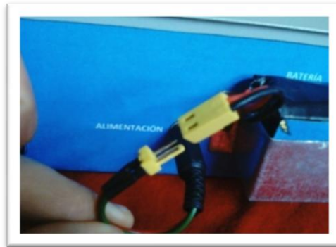
Figura 89. Sentido correcto para conexión entre la batería y el cable de alimentación del transmisor de FM. Fuente: Autor del texto.
