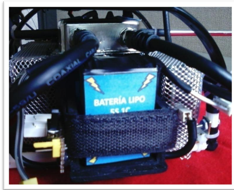
Figura 105. Correcta instalación de la batería Lipo 5S 1C en su correspondiente compartimento. Fuente: Autor del texto.
