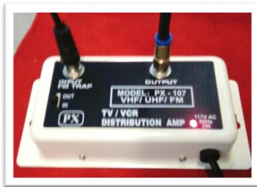
Figura 120. Amplificador de señal RF para televisión y su correcta instalación. Fuente: Autor del texto.
