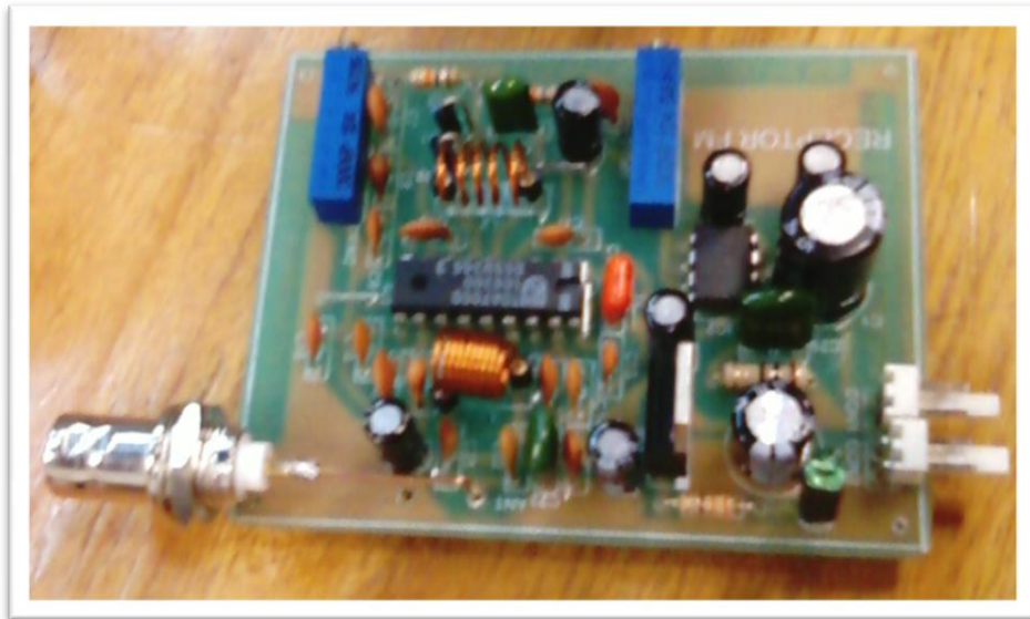
Figura 51. Circuito impreso del receptor de FM elaborado en fibra de vidrio. Fuente: Autor del texto.
