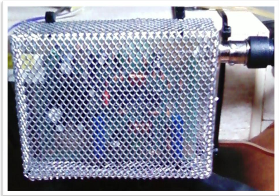
Figura 55. Receptor de FM en jaula de Faraday fabricada en malla metálica. Fuente: Autor del texto.
