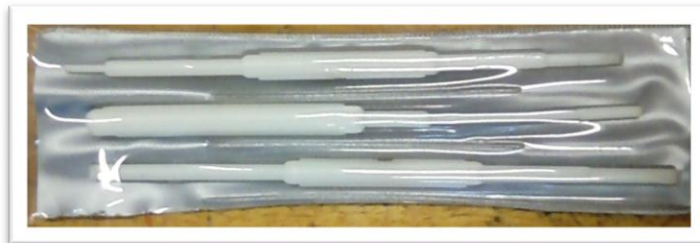
Figura 121. Destornilladores no metálicos. Fuente: Autor del texto.
