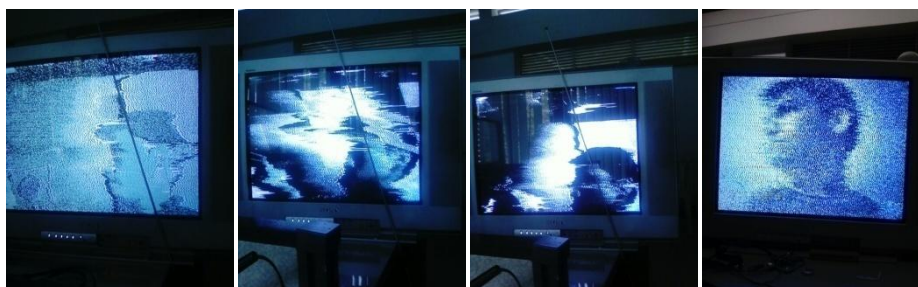
Figura 83. Transmisor de AM para video desajustado. Fuente: Autor del texto.
