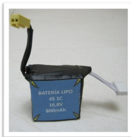
Figura 42. Paquete de baterías Lipo para alimentar al transmisor de FM. Fuente: Autor del texto.
