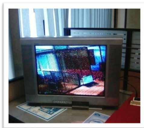
Figura 84. Transmisor de AM para video ajustado. Fuente: Autor del texto.
