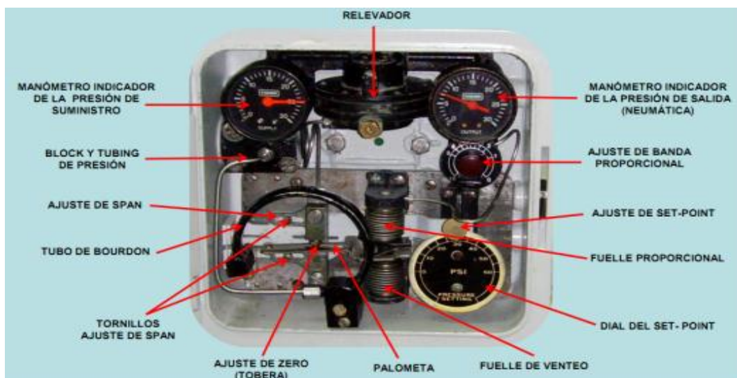
Figura 33. Partes Internas del Controlador de Presión WIZARD 4150K
