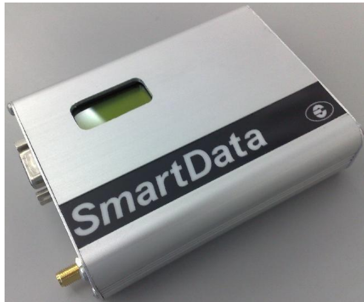
Figura 93. Módem SmartData III [11].
