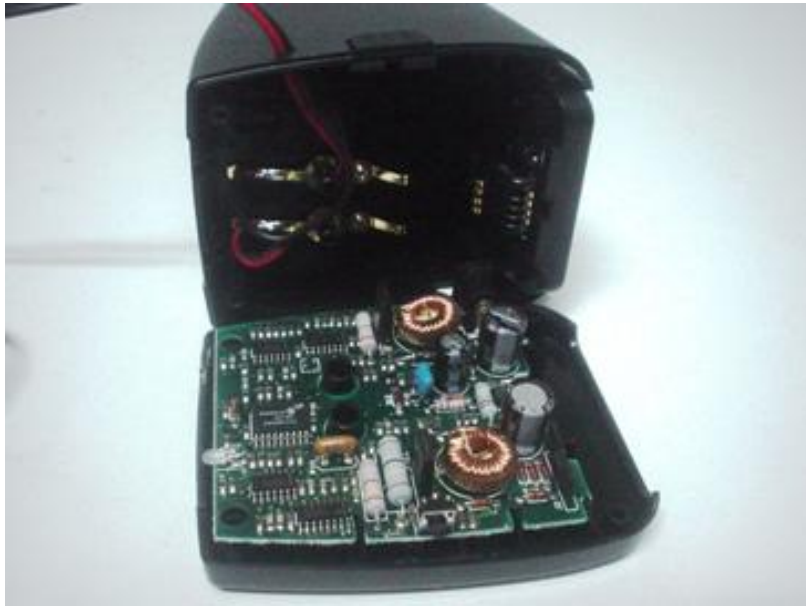
Figura. 51. Cargador en proceso de modificación.
