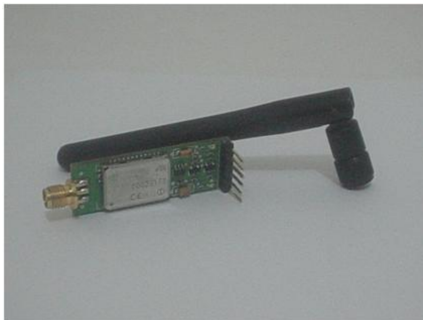
Figura. 46. Antena utilizada para la conexión Bluetooth.
