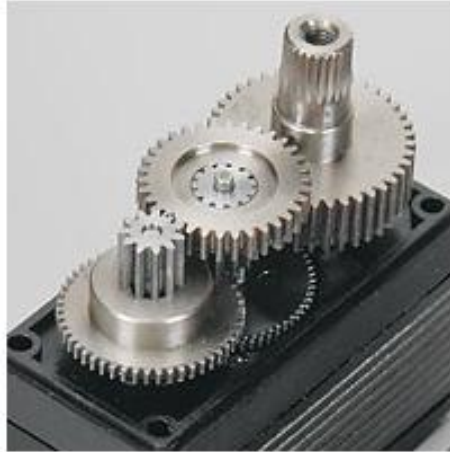
Figura. 12. Servo de engranajes metálicos. 20
