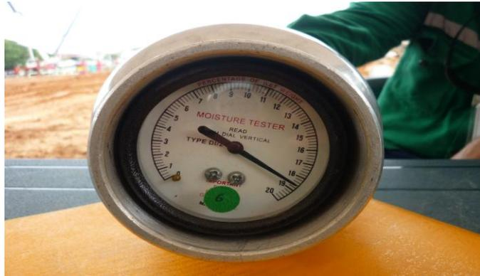
En dicha foto 58 se muestra el speedy o Humedometro empleado por el practicante para tomar la medición de la humedad hasta encontrar la óptima.
