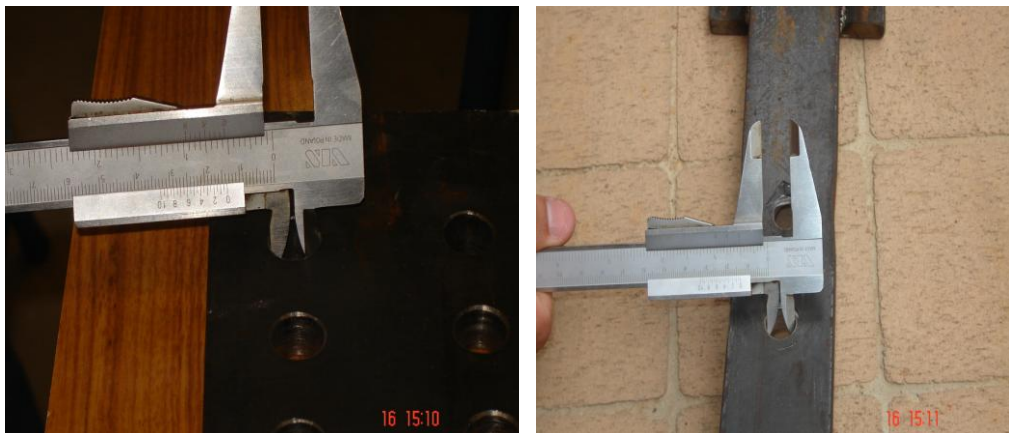
Foto No 4: Tamaño de las Perforaciones de los pernos a usar.
