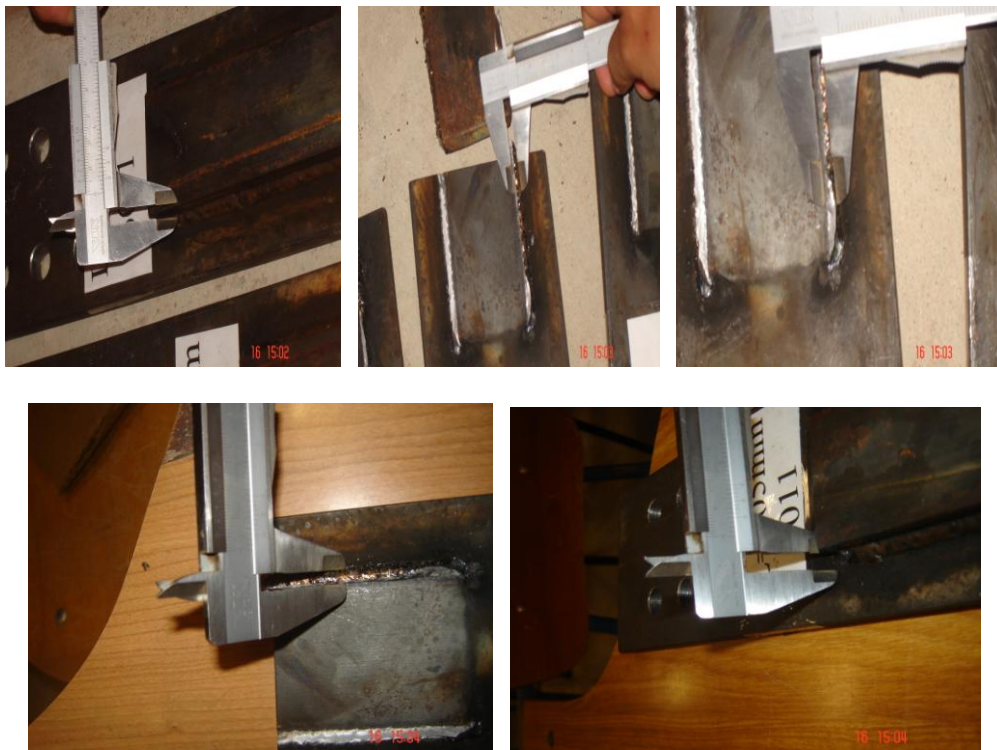
Foto No 16: Espesor Teórico Real de la Longitud de Soldadura 5 medidas.
