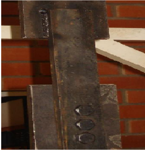
Foto No 2: Conexión Platina (Pernada) – Platina (Soldada).
