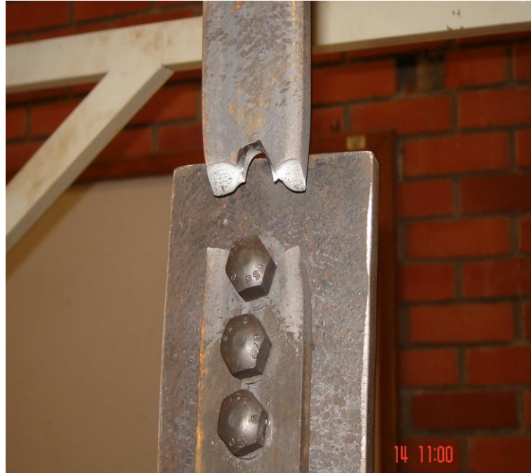
Foto No 11: Platina Fallada por Fractura en Platina 2" * 1/2".
