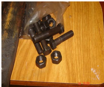
Foto No 9: Pernos de 4" * 1/2" y 2" * 1/2" del Sistema - Mordazas.
