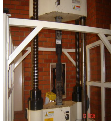
Foto No 7: Maquina Universal – Montaje del Sistema.
