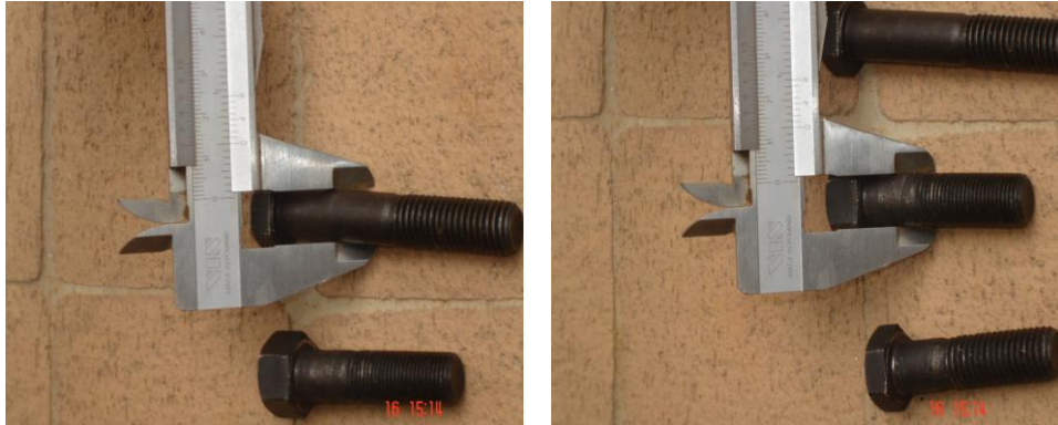
Foto No 5: Espesor de los Pernos a Usar.
