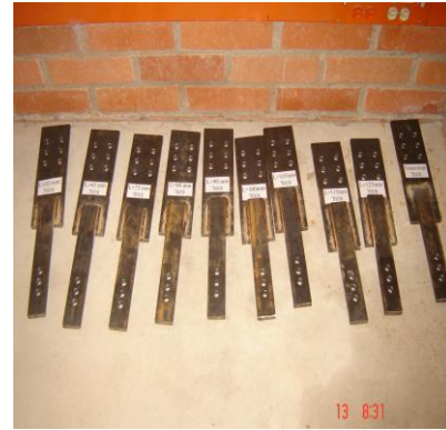
Foto No 8: Platina con Soldadura 6011 – con Soldadura 7018.
