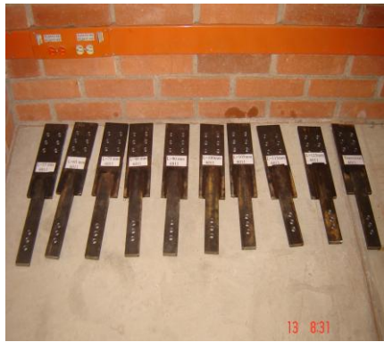
Foto No 8: Platina con Soldadura 6011 – con Soldadura 7018.
