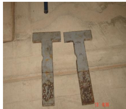
Foto No 9: Pernos de 4" * 1/2" y 2" * 1/2" del Sistema - Mordazas.
