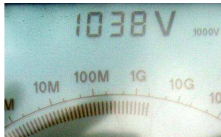
Figura 141. Aplicación de 1000v en motor 144
