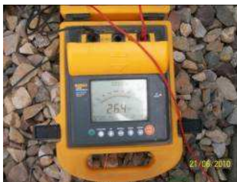
Figura 122. Conexionado del megguer 125
