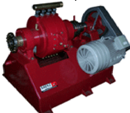
Figura 15. Banco de pruebas Saenz AT para motores de alto torque
