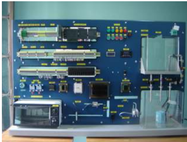
Figura 11. Modulo con sensores control nivel y temperatura [7]
