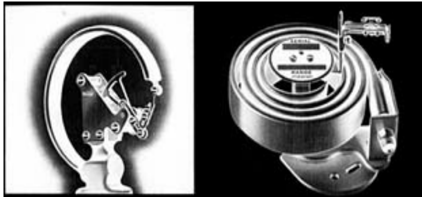
Figura No 17: Tubo Bourdon en C y en espiral.[9]
