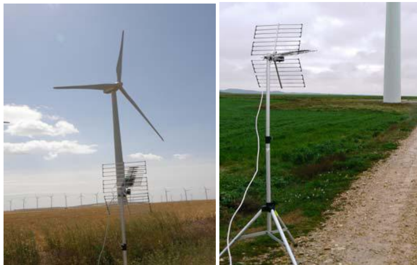
Figura 13. Antena Transmisora y Receptora para medición de RCS sobre un Aerogenerador
