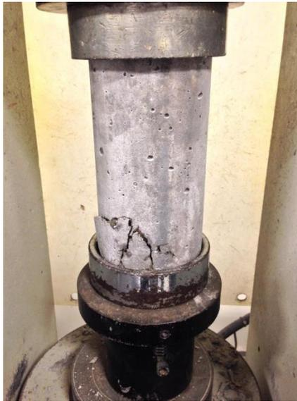
**Figura 18.** Resistencia a la compresión
