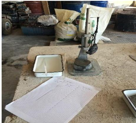
**Figura 8.** Tiempo de fraguado del cemento hidráulico método del aparato de Vicat
