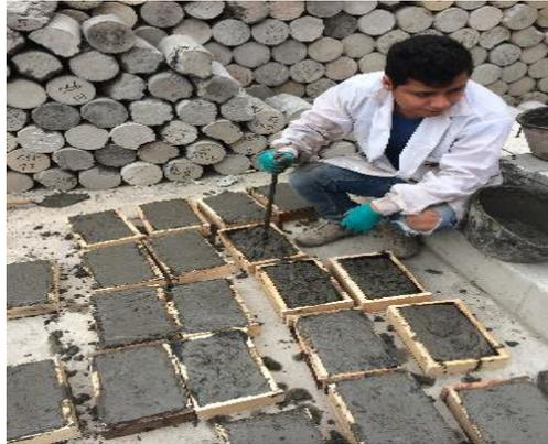
**Figura 22.**Elaboración adoquines de concreto
