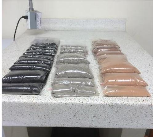
**Figura 11.**Cenizas Volantes
