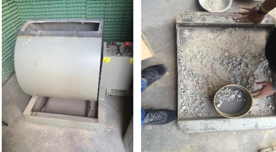
**Figura 7.** Resistencia al desgaste de agregados tamaños menores de 1 ½” por medio de la máquina de los ángeles (INV. E-218)
