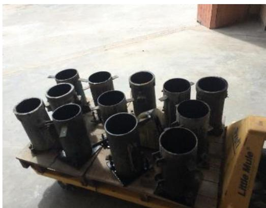
**Figura 15.**Moldes cilíndricos para concreto
