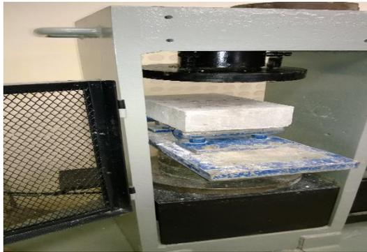
**Figura 24.** Resistencia a la flexo-tracción – Modulo de rotura ( $M_r$ )
