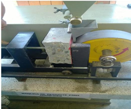
**Figura 25.** Resistencia a la abrasión
