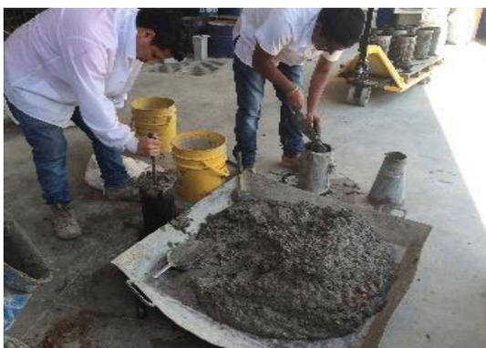
**Figura 17.**Proceso de elaboración de los especímenes
