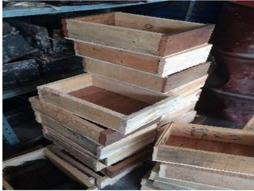
**Figura 20. Molde para especímenes de un adoquín**
