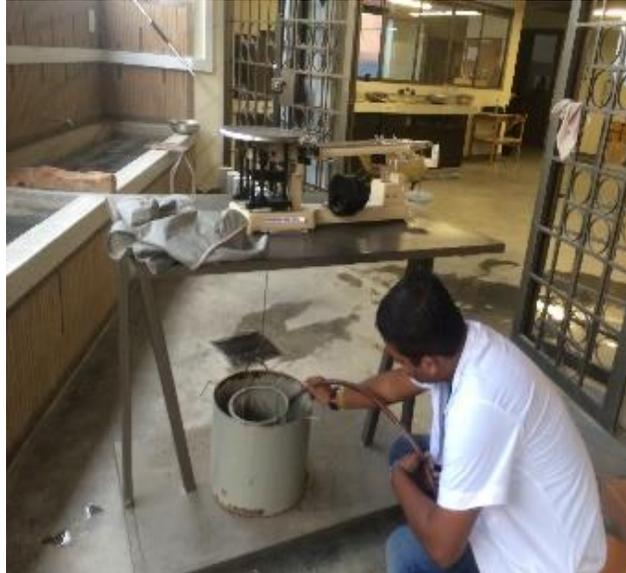
**Figura 5.**Gravedad específica y absorción de agregados gruesos (INV. E-223)
