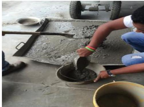
**Figura 21. Mezcla de concreto fluida**
