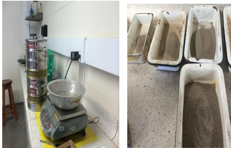
**Figura 4.** Granulometría agregado fino
