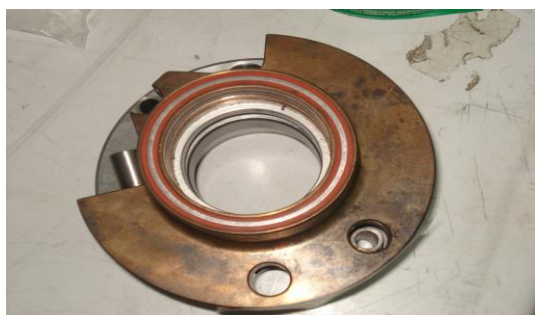
FIGURA 16. BRASS PLATE QUE CONECTA CON LOS POGO PINS DEL PIN END
