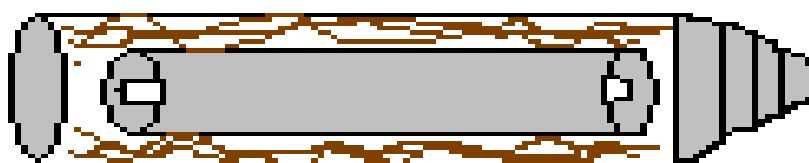
FIGURA 24. FLUJO DE LODO POR FUERA DE LA HERRAMIENTA
