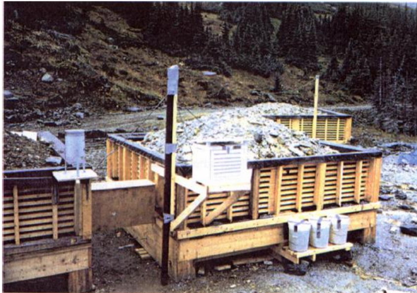
Imagen 13. Test a escala de campo para identificación de formación de DAM
