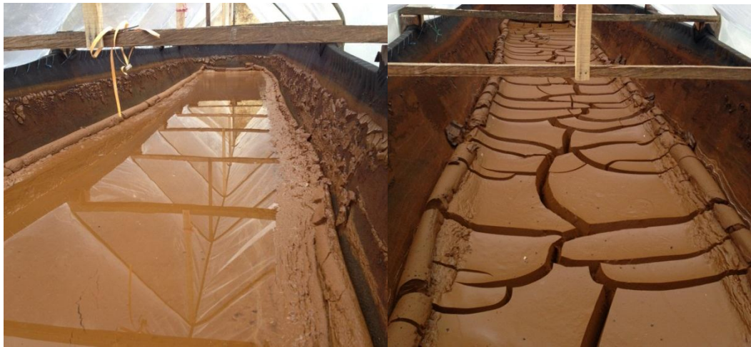
Imagen 23. Manejo de Lodos provenientes del Tratamiento de DAM
