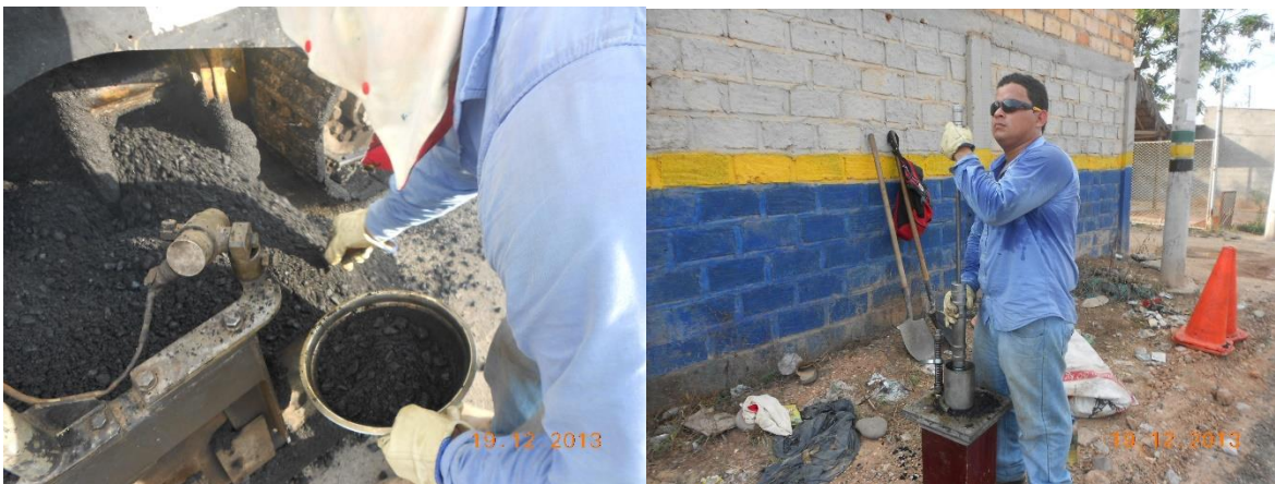
Ilustración 1: Toma de briquetas y temperatura para control de calidad (Autor).
