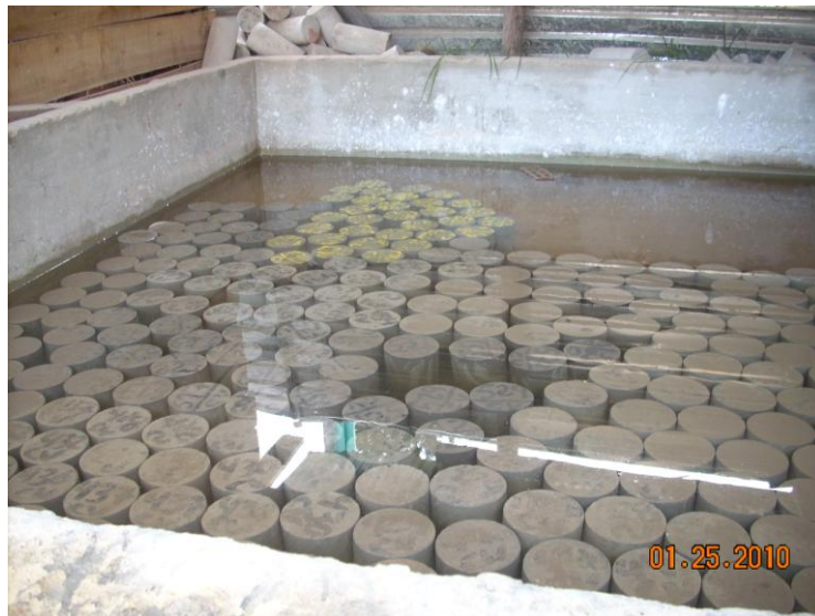
FOTO 19. Curado de cilindros de concreto en obra
