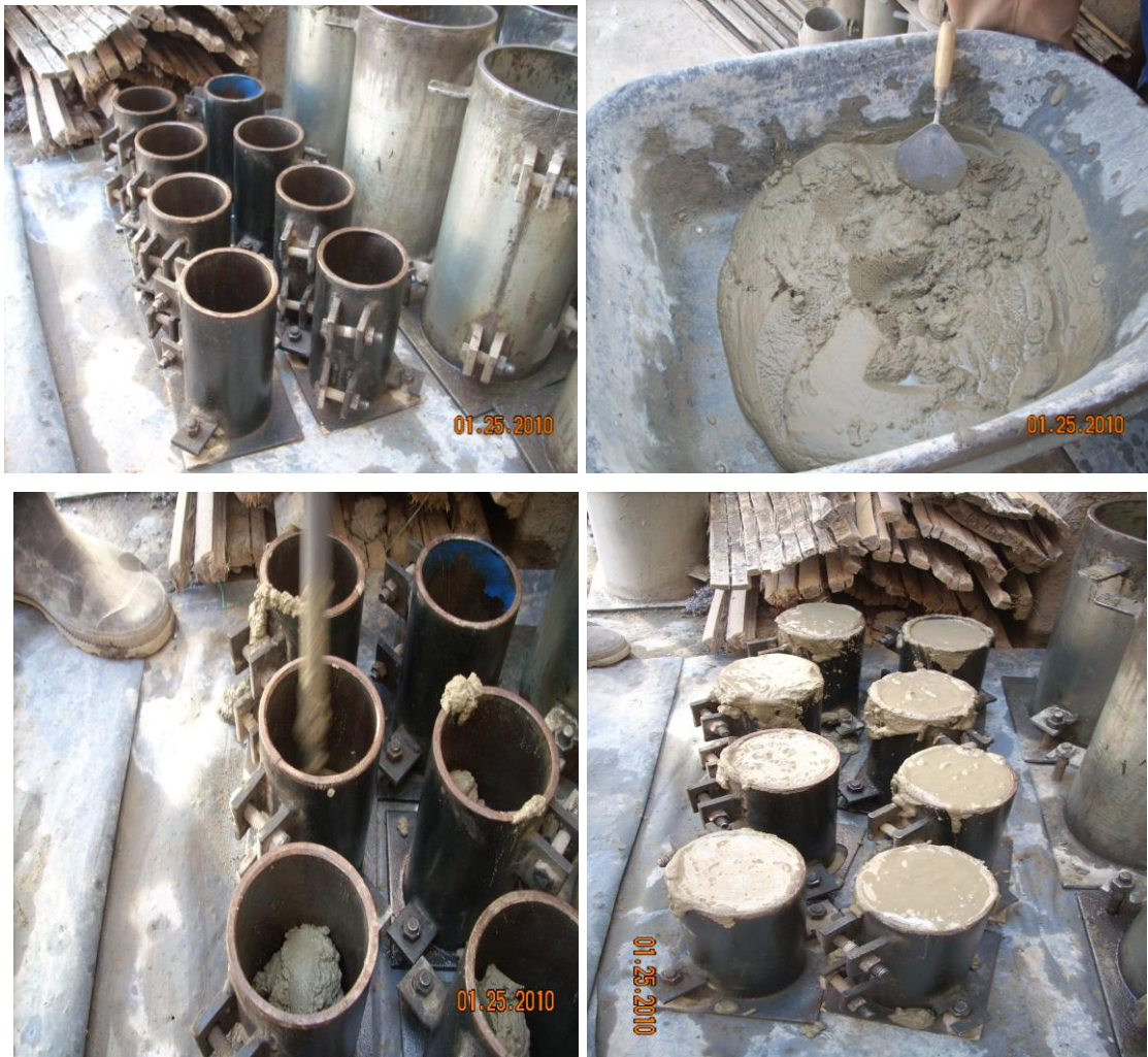
FOTO 25. Elaboración de muestras de mortero en obra.
