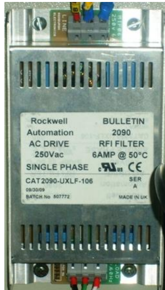
Figura 100: Filtro monofásico AC [74]
