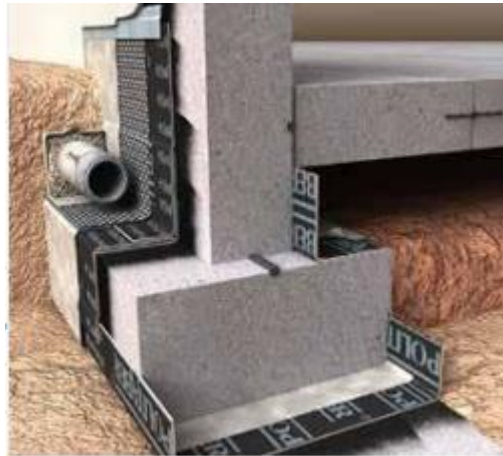
Figura 29. Impermeabilización de cimentaciones. Fuente: Chova
