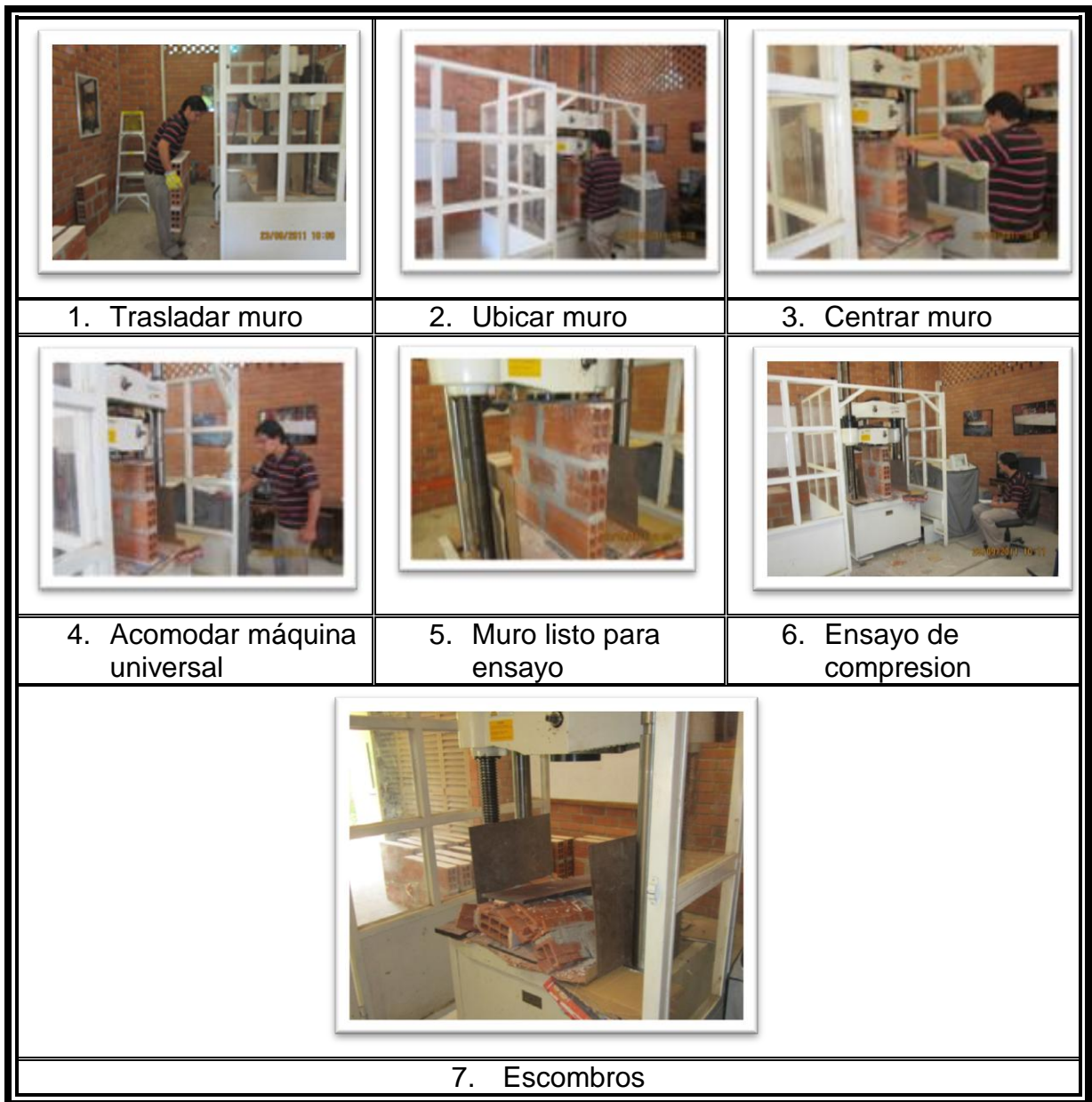
Figura 28. Ensayo De Resistencia a La Compresión de Muros Con Ladrillo. Fuente: Propia
