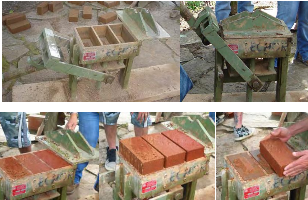
Figura 4. Etapas De Fabricación De Los BTC. Fuente: NEVES, Célia y BORGES FARIA, Obedes. Técnicas De Construcción Con Tierra.
