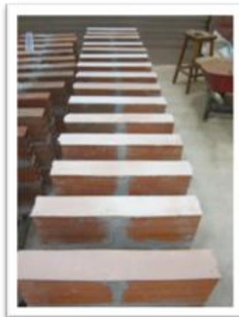
Figura 27. Refrentado De Muretes Con Ladrillo Tradicional. Fuente: Propia
