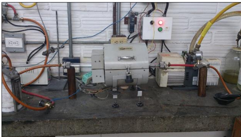
Figura 3.3. Equipo de síntesis de nanotubos de carbono por CVD [43]
