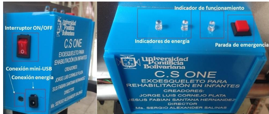
Figura 33. Componentes de la caja de control
