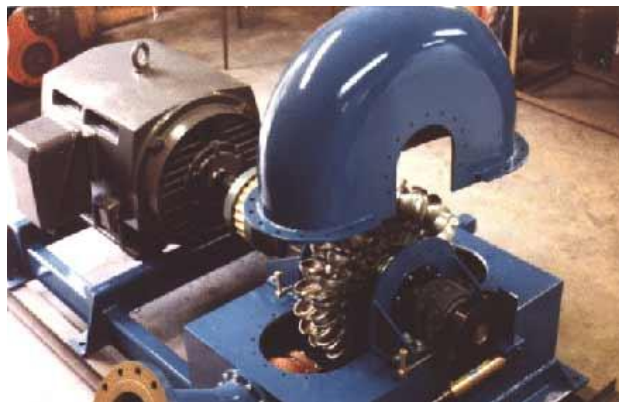
Figura 9. Conjunto de una Turbina Pelton
