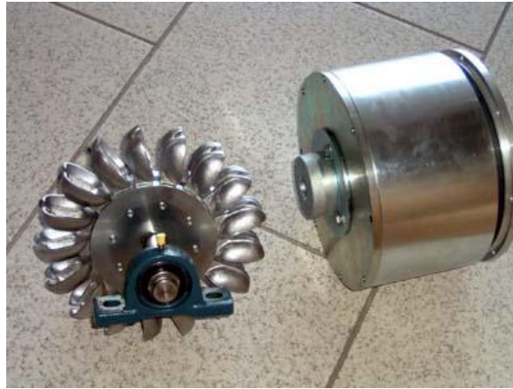
Figura 11. Conjunto Turbina Pelton/Alternador.
