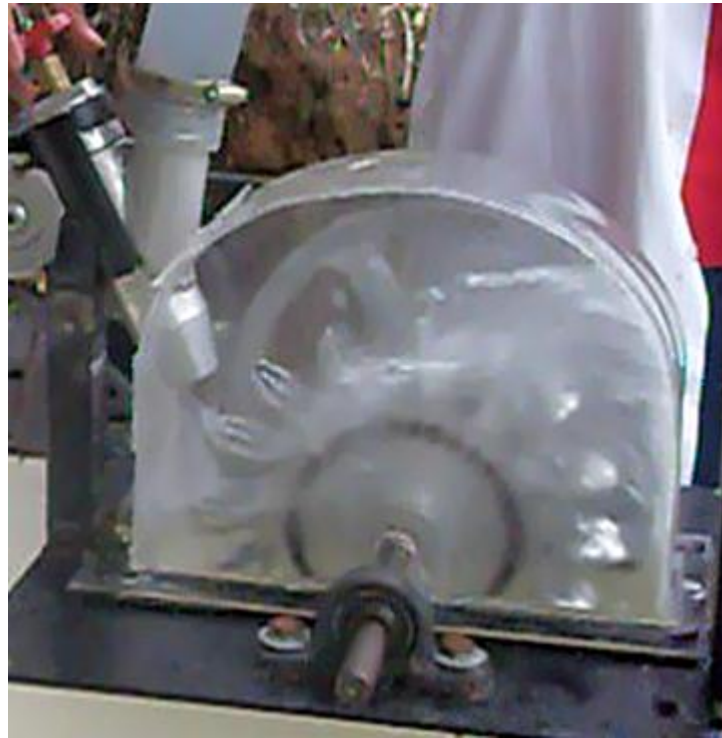
Figura 58. Montaje Turbina Pelton Vista Perfil
