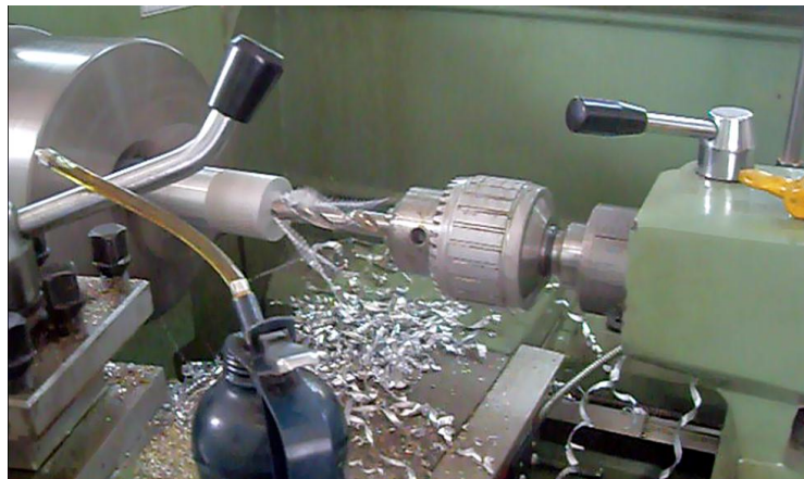
Figura 51. Proceso de Torneado del Inyector
