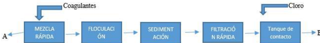
Imagen 1: Proceso convencional de tratamiento de agua potable
