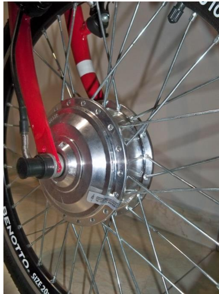
Figura 35: Motor eléctrico ubicado en la llanta delantera.
