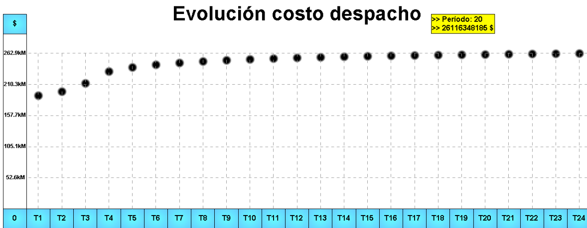
Figura 4.14. Comportamiento del costo total de cada uno de los despachos ocurridos en cada uno de los 24 períodos de 96 horas cada uno, dado en unidades monetarias (Caso 4.2.4).
