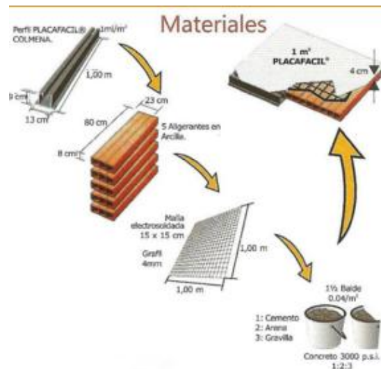
Figura 15. Materiales empleados para la construcción de la Placa “Fácil”
