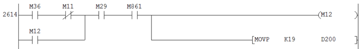
Figura 25: Verificación HOME y unidad hidráulica.
