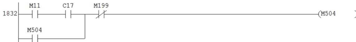
Figura 29: Acción de alarma.
