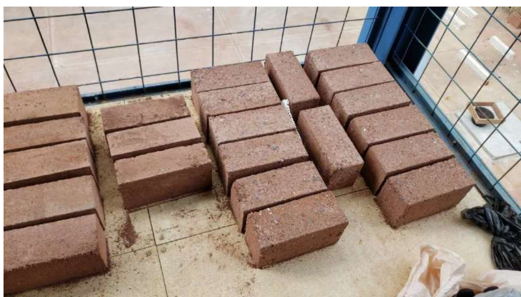
Figura 5- BTCE con concreto triturado y plástico molido (Beltran Niño & Gomez Barragan, 2023)
