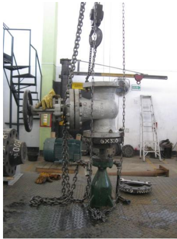
Figura 22. Prueba de hermeticidad a una de las caras de la válvula
