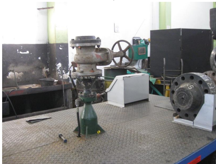
Figura 23. Prueba de hermeticidad al cuerpo de la válvula
