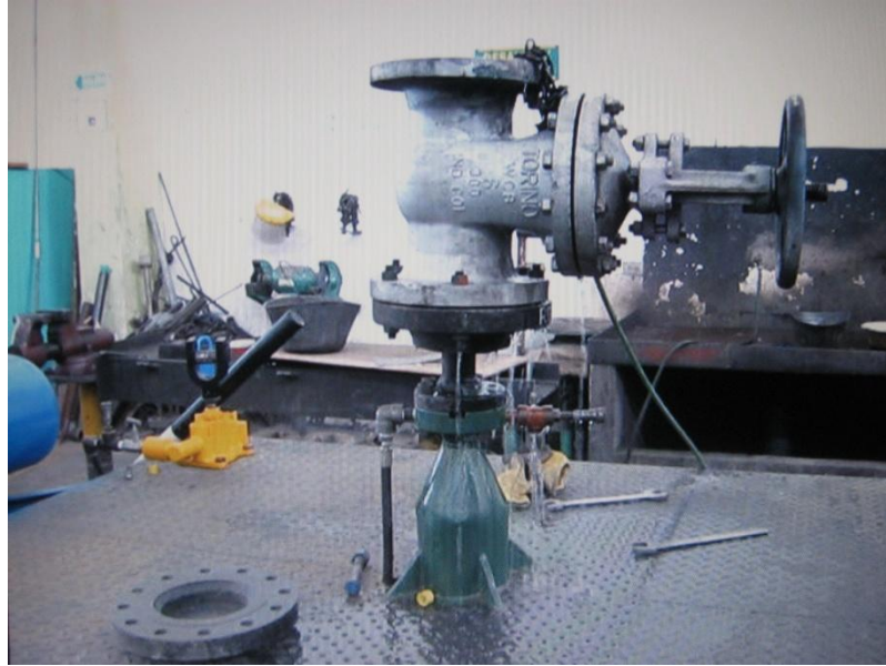
Figura 20. Prueba de drenaje del banco de pruebas
