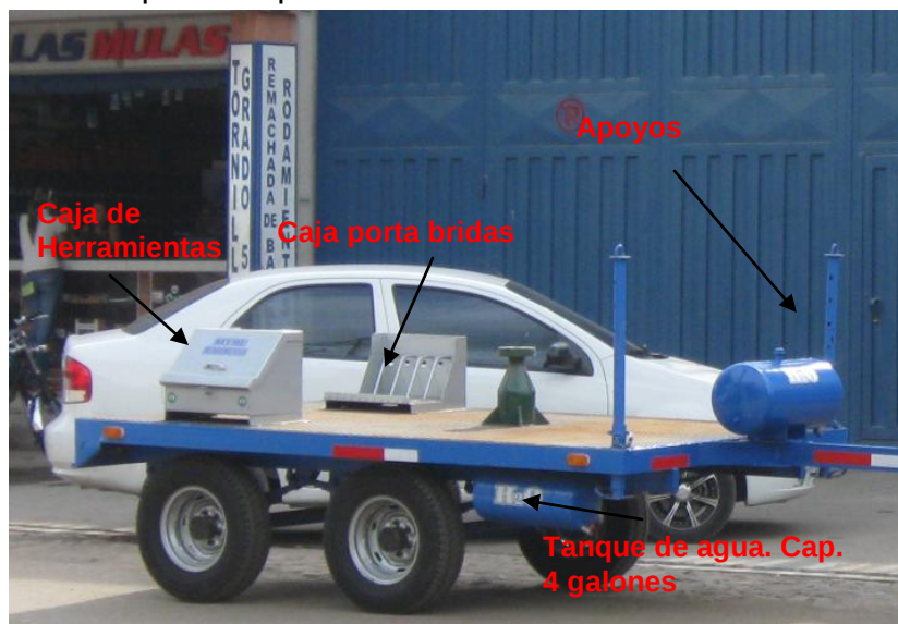
Figura 13. Banco de pruebas para válvulas industriales
