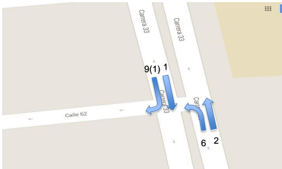
Figura 43. Movimientos vehiculares, intersección Cra 33 – Calle 62 Fuente: Elaboración propia, tomada de Google Earth.
