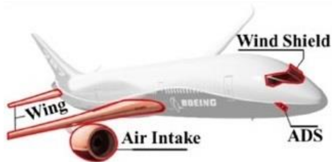
Figura 44. Zonas propensas a la formación de hielo en una aeronave [54]
