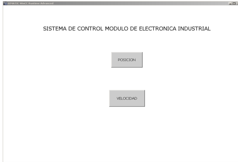
Figura 10. Ventana de inicio de la HMI en SIMATIC WinCC Runtime Advanced.
