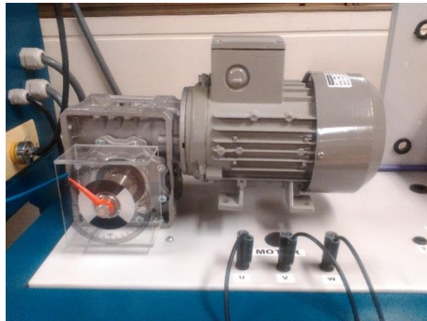
Figura 3. Motor de inducción del módulo de posición o velocidad
