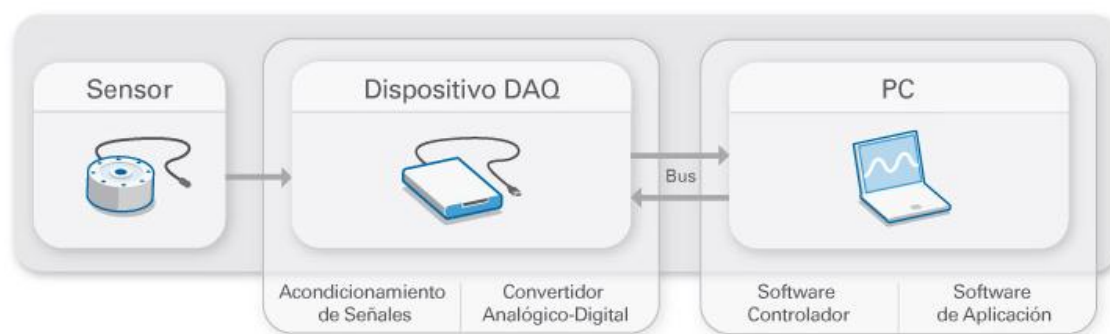
Figura 10. Proceso de un sistema de adquisición (National Instruments, 2017).
