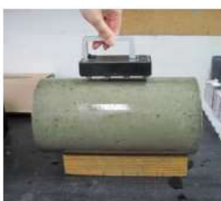
Figura 3. Método de las 4 puntas
