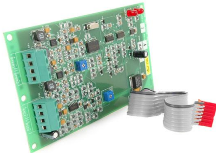
Figura 52. Modulo de voz doble vía
