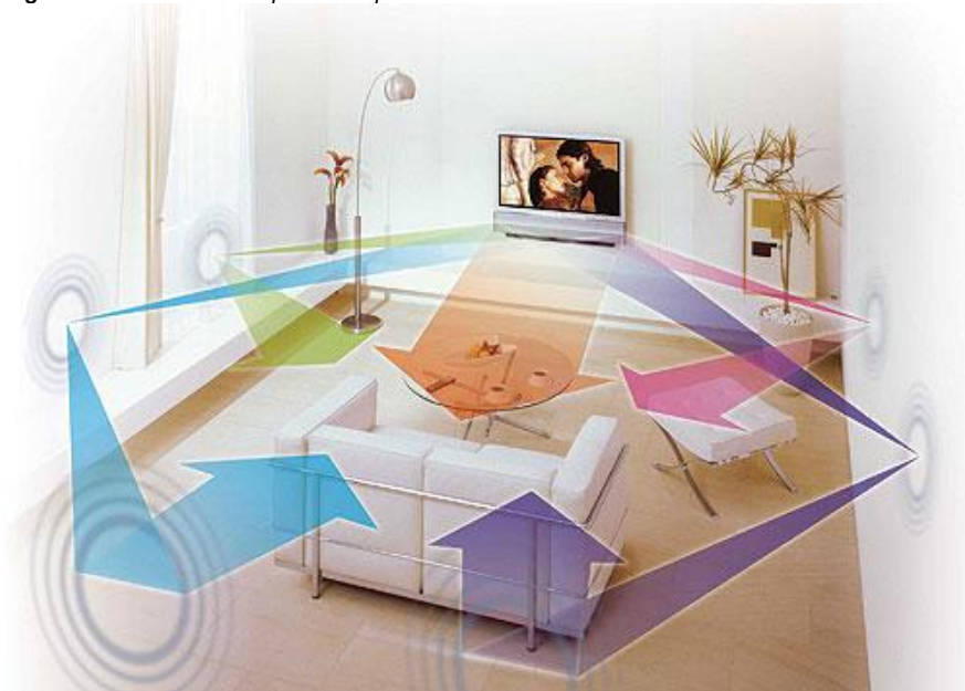
Figura 90 distribución de parlantes para crear un sonido envolvente
