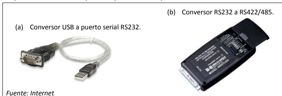
Figura 12. Dispositivos utilizados para disponer de un puerto RS485 en el PC
