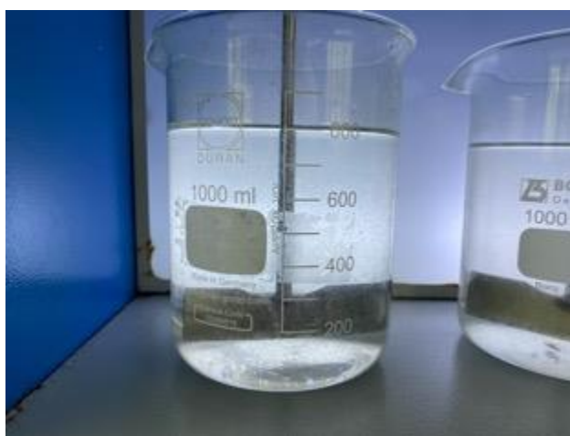
Ilustración 19: Test de jarras. Fuente: Autor.
