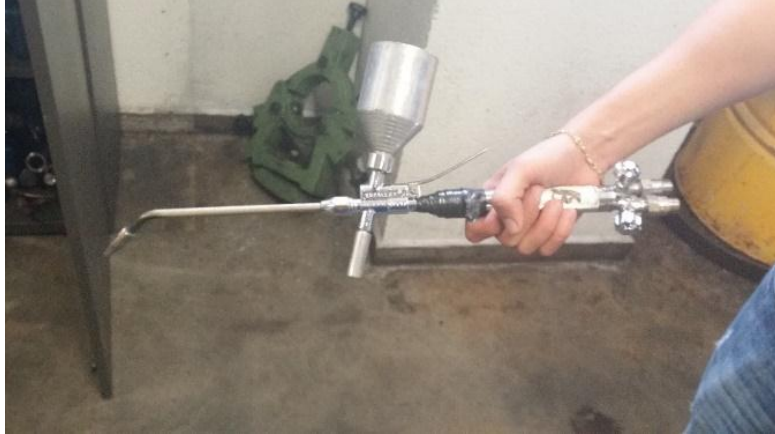
Figura 15 Pistola de proyección térmica por llama
