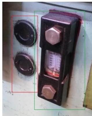
Figura 8. Comparación de mirilla nueva (cuadro verde) y mirilla antigua (cuadro rojo).
