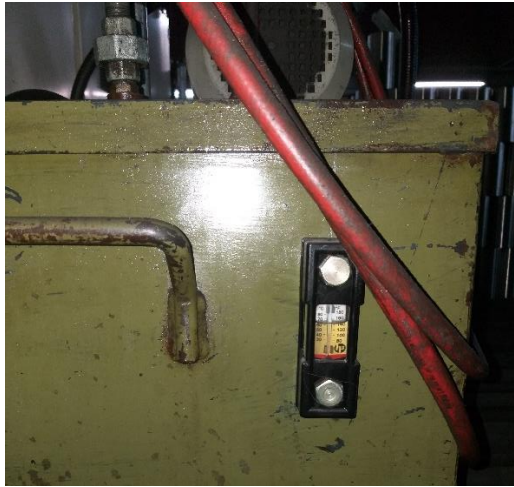
Figura 13. Mirilla de nivel de lubricante ubicado en unidad hidráulica CNC M058.
