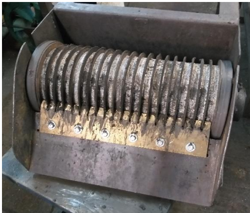
Figura 10. Desimantador con uñas en bronce nuevas.
