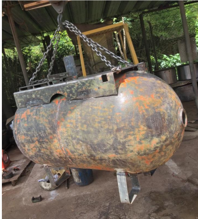
Figura 23. Tanque del compresor M046 listo para ser pintado.
