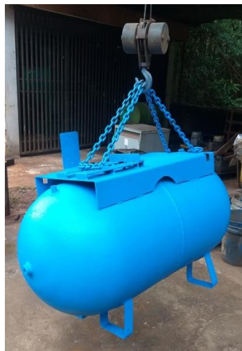
Figura 24. Tanque de compresor M046 pintado.
