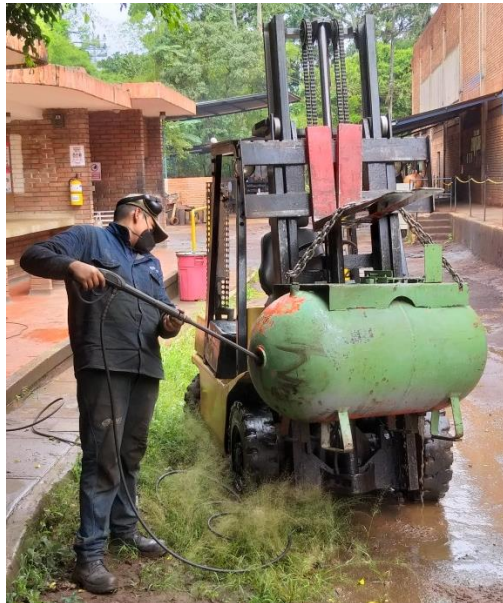
Figura 20. Lavado a presión tanque del compresor M046.
