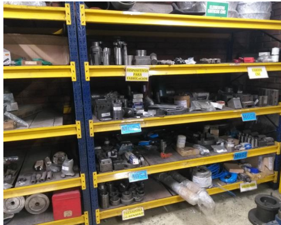
Figura 5. Estantería del almacén de repuestos críticos en orden y señalizada.
