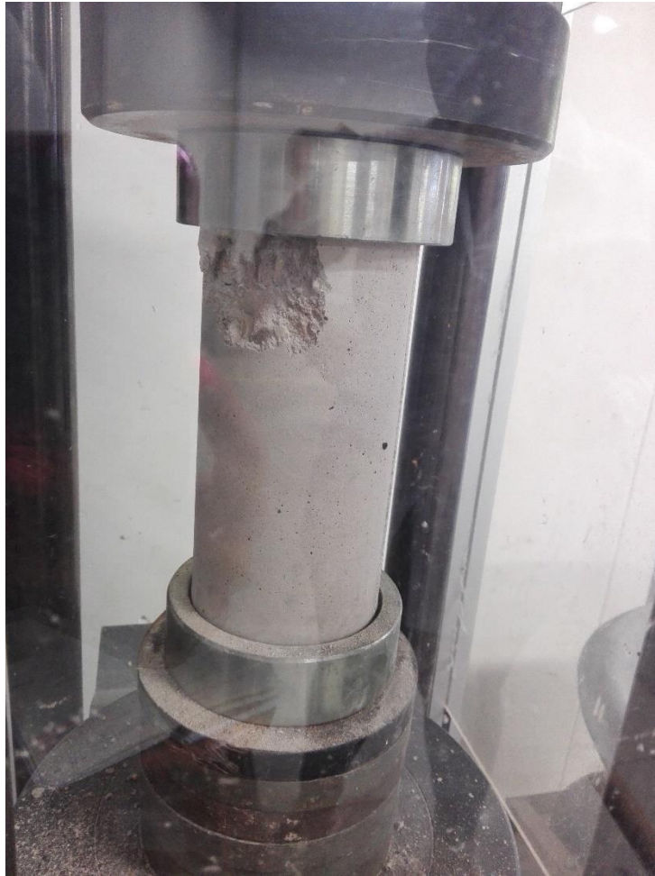
Figura 33 – Ensayo de control de calidad al concreto de la placa
