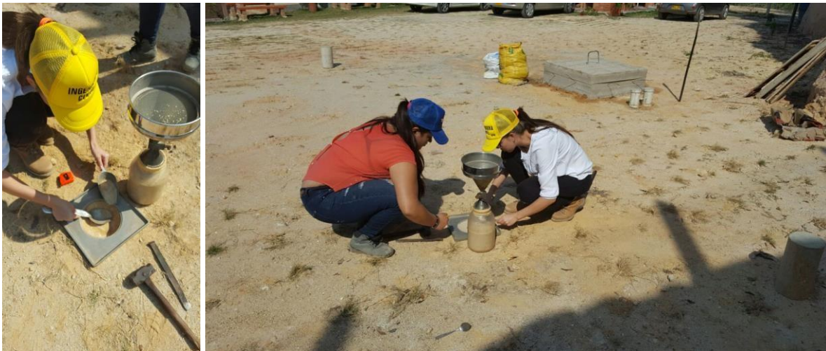
Figura 24 – Ensayos de cono de arena, condiciones pre-compactación
