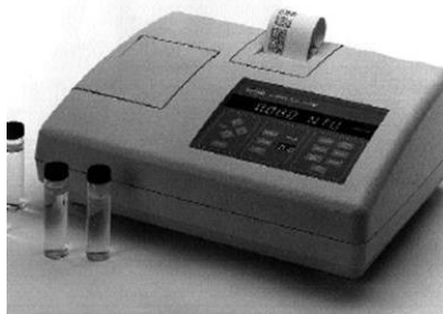
Figura 3. Turbidímetro - HACH 2100AN.
