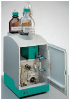
Figura 9. Cromatógrafo - METROHM COMPACT IC 761.
