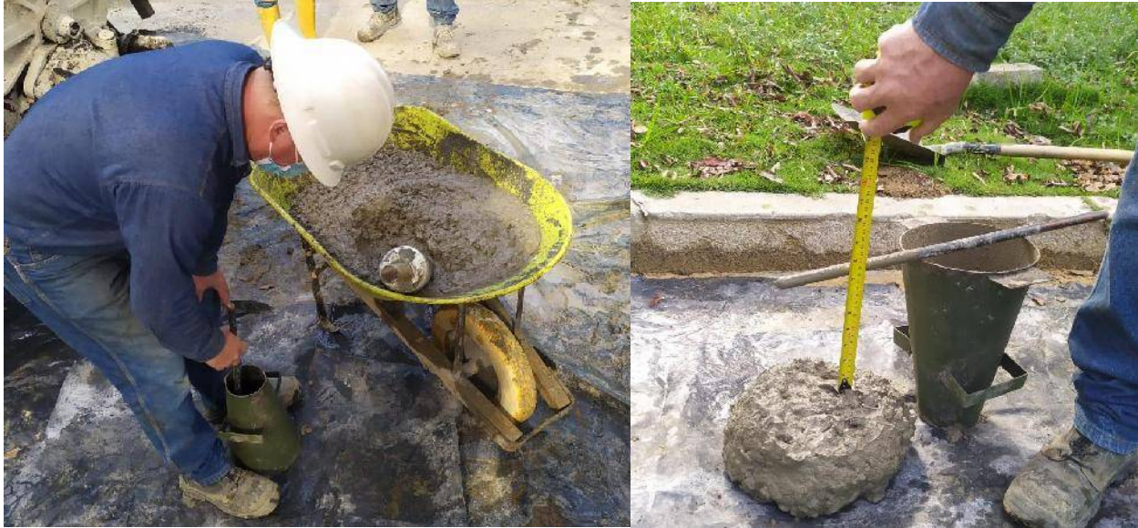
Figura 42. Ensayo de Slump
