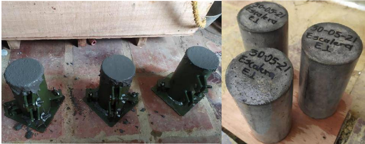
Figura 45. Probetas Cilíndricas de Concreto Fuente: Autor
