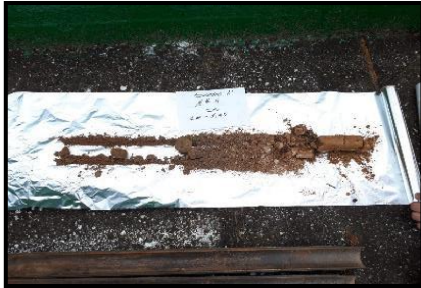
Imagen 1: Cuchara partida, con muestra extraída
