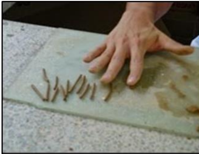
Imagen 3: Rollo de diámetro no mayor a 5 mm
