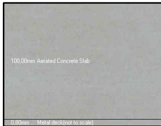
Figura 13. Capas, cubierta convencional. Fuente. Elaboración Propia.
