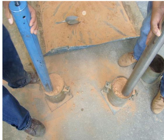
Figura 10. Compactación del suelo con 5 capas de 56 golpes cada una.
