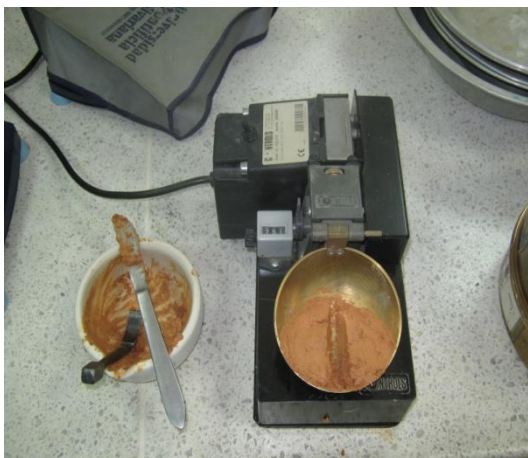
Figura 5. Material listo para ejectar en la copa de casagrande.
