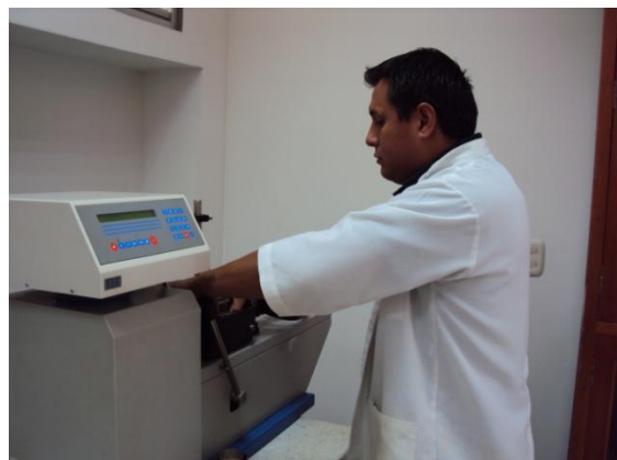
Figura 12. Montaje de la muestra y aplicación de carga y velocidad.
