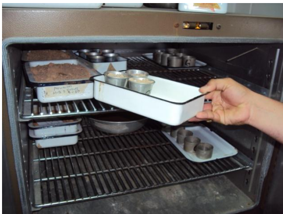
Figura 7. Horno utilizado para el secado de las muestras.
