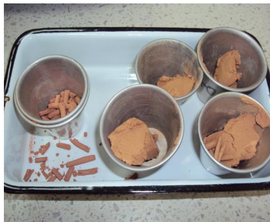
Figura 6. resultado obtenido del ensayo de plasticidad.
