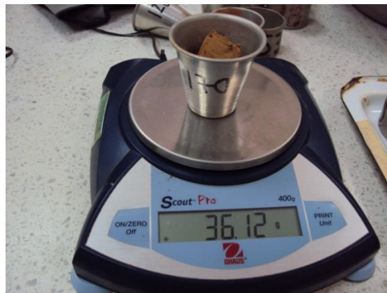
Figura 8. Balanza digital para el control del peso de cada una de las capsulas.
