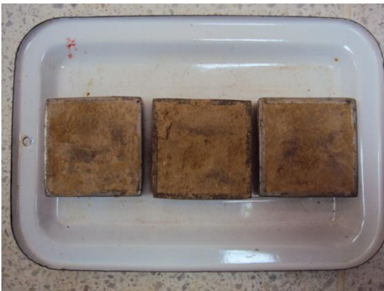
Figura 11. Muestras de un corte que están listas para ser falladas en la máquina de corte directo
