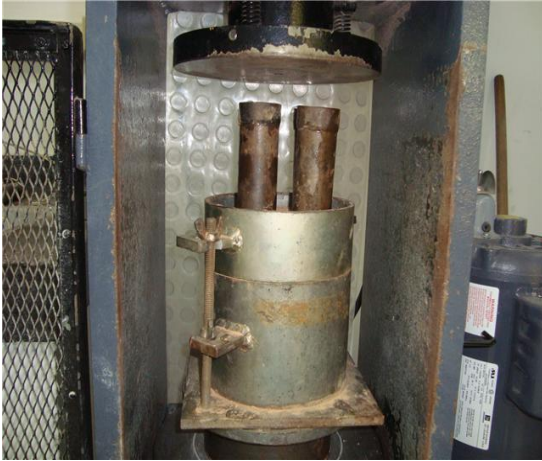
Figura 13. Toma de muestras para el ensayo de compresión simple.
