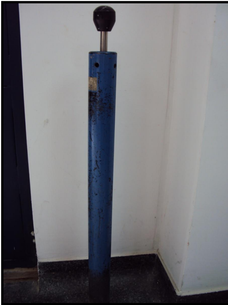
Figura 3. Pisón usado para la prueba Proctor modificado.
