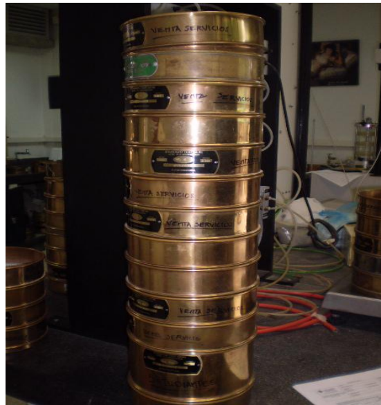
Figura 4. Selección de tamices que se utilizarán, previamente ordenados.
