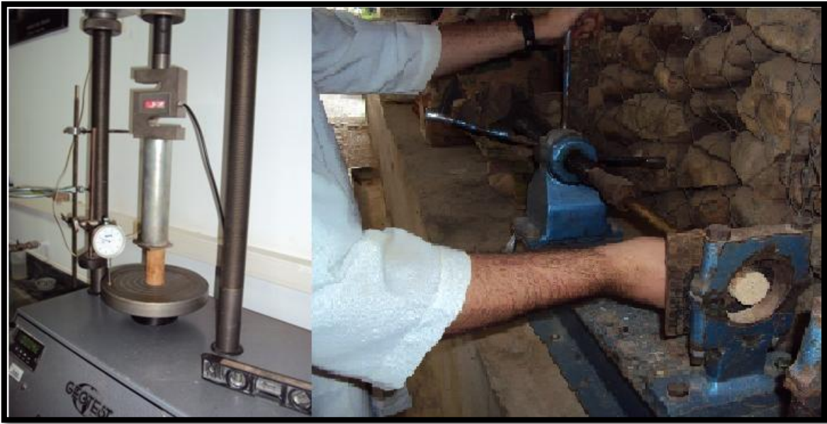
Figura 7. Extracción de la muestra y prueba de compresión no confinada.
