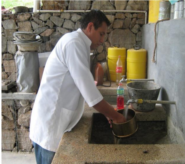
Figura 3. Lavado del material seleccionado por el tamiz N° 200.
