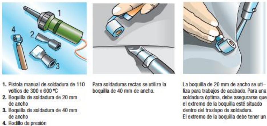
Figura 18, Pistola leister, instalación de membrana PVC Fuente: Manual de aplicación línea SikaPlan, Sarnafil, Sika Colombia.
